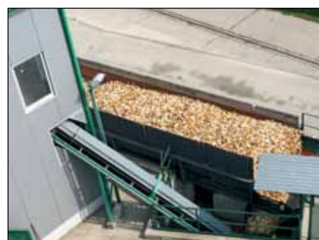
Otvorená prijímacia časť bola koncipovaná ako pozdĺžny žlab umožňujúci nákladným vozidlám zadné aj bočné sypanie.
